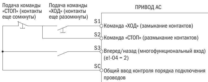
Рис. 6.26. Схема трехпроводного подключения управлением преобразователя
